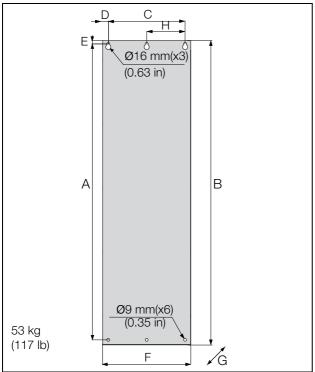
Fig. 22 Emotron VFX/ Model 48-142 to 48-171 (Frame size E2).
