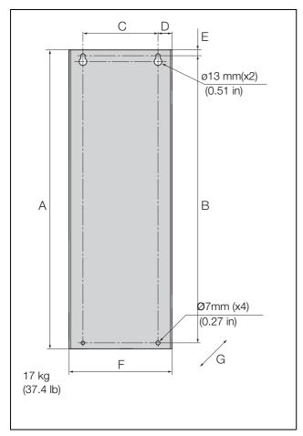
Fig. 12 Emotron VFX Model 69-002 to 025 (Frame size C69).
