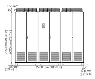
Emotron VFX48: Model 2K25 (Frame size N) Emotron VFX69: Model 1K8 (Frame size N69)
